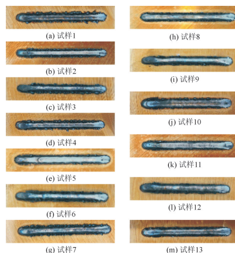
图8 各个工艺参数下熔覆层的表面形貌
